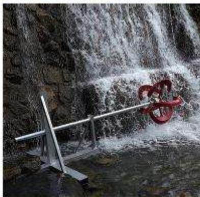
複合式水風力發電機之水力發電模組
