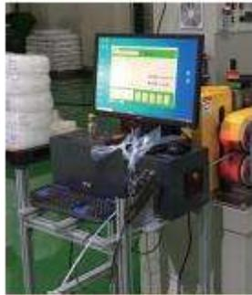
押出管瑕疵檢測
